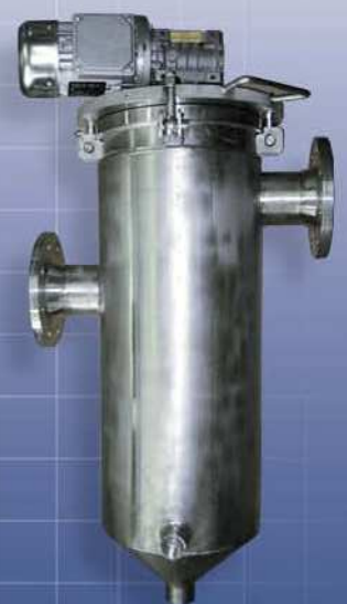
Kantenspaltfilter AS175-FD mit Heizmantel und Sondermotor zur Filtration von Schokoladenmasse
